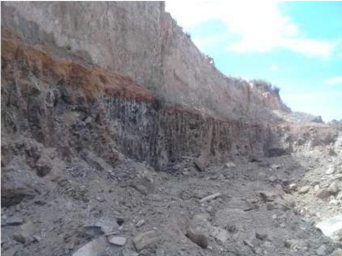
**Figura 03.** Fotografia retirada em uma pequena mineração em Livramento. Neste local estão trabalhando os filitos de cor escura, que ocorrem disseminados com ouro fino.
